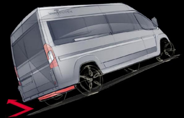
Der abgewinkelte Tank verhindert das Aufsetzen am Berg.
